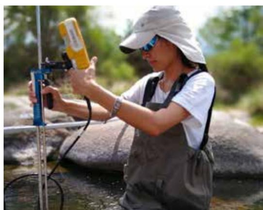
Medición de caudal con Velocímetro Acústico Doppler (ADV).
